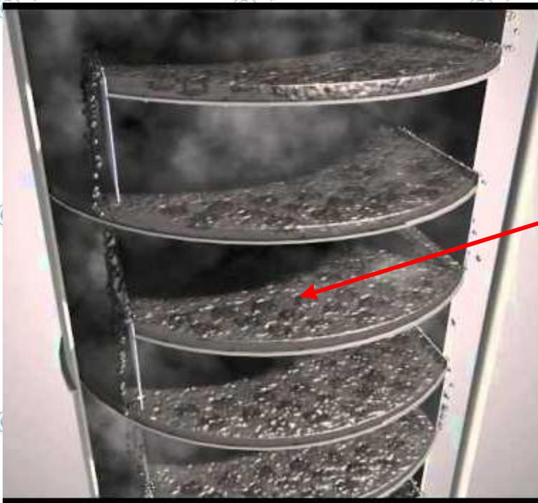
При установившейся работе ректификационной колонны на тарелке температура, давление, составы жидкости и пара в любой точке должны оставаться постоянными и не меняться во времени
