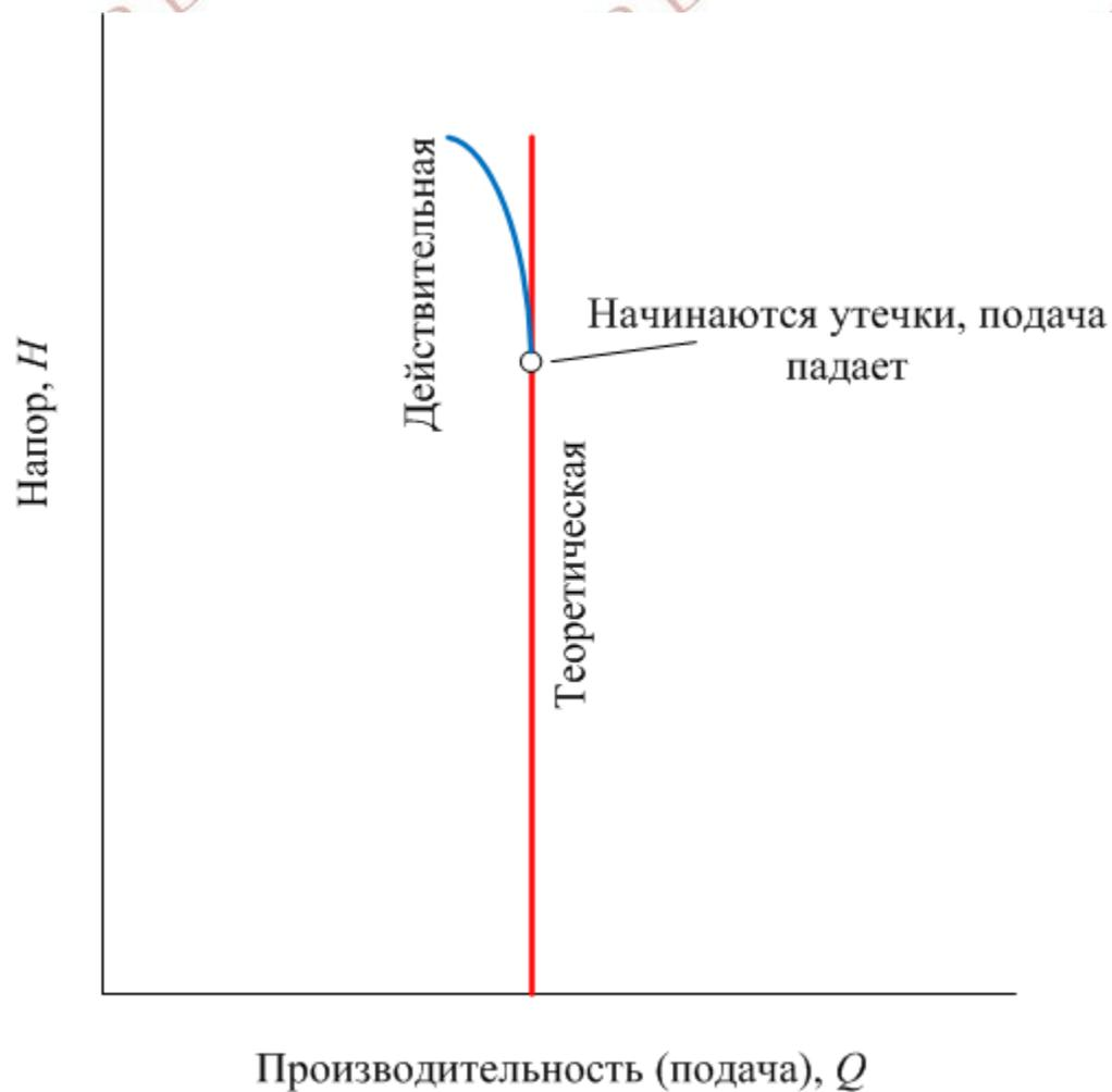
Если сравнивать поршневые и плунжерные насосы, то первые применяются чаще – они проще и дешевле. Плунжерные реже – у них существенно больше поверхность контакта между корпусом и вытеснителем, что позволяет значительно лучше уплотнить рабочую камеру.
