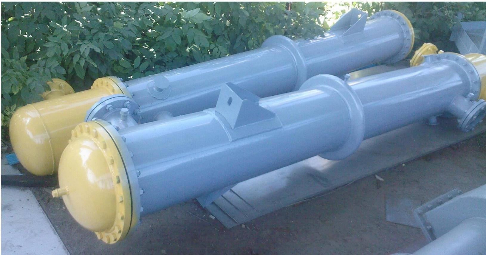
Штуцер для входа в межтрубное пространство (верхний) имеет больший диаметр, чем для выхода. Следовательно, объёмные расходы потоков различны. Почему?
