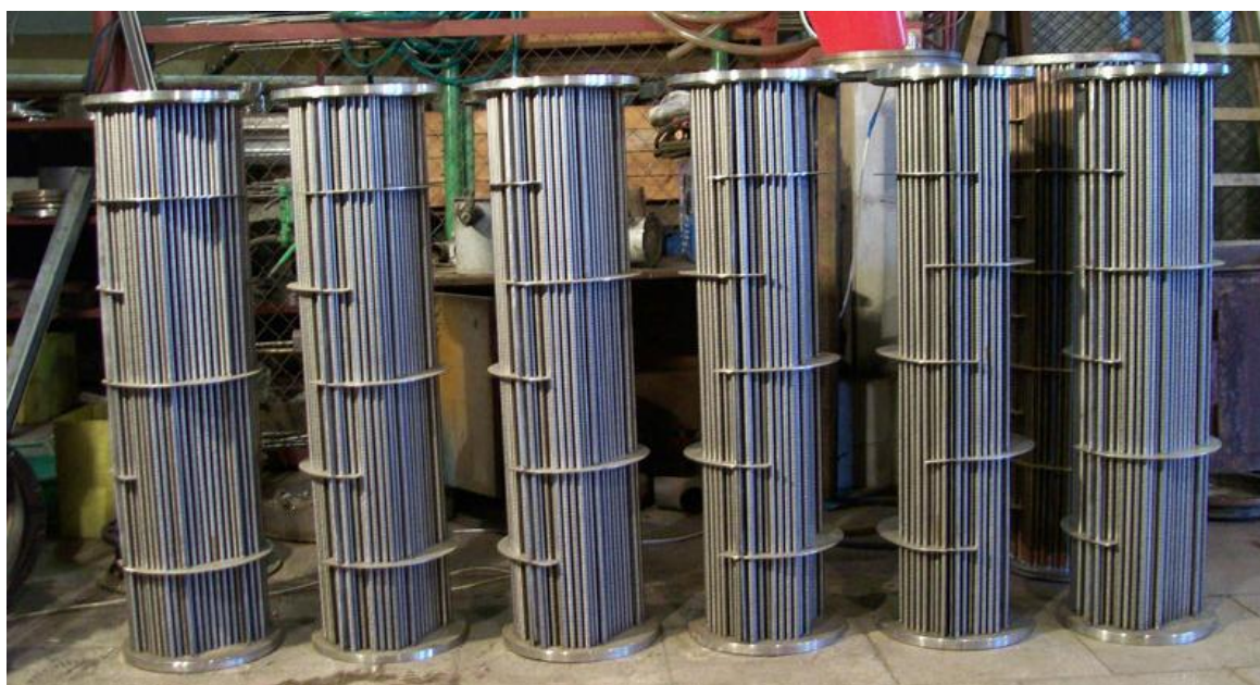
Рис. 5. Трубный пучок кожухотрубчатого теплообменник с перегородками в межтрубном пространстве 2
