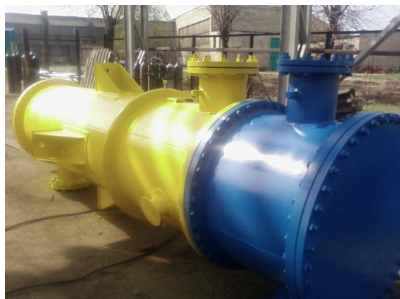
Рис. 7. Двухходовой кожухотрубчатый теплообменник. 1 – крышка распределительной камеры; 2, 6 – штуцеры трубного пространства; 3, 5 – штуцеры межтрубного пространства
