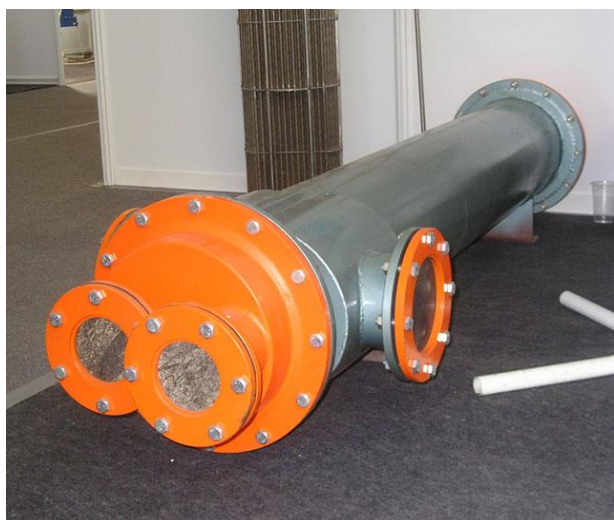
Рис. 8. Двух- и более ходовые кожухотрубчатые теплообменники
