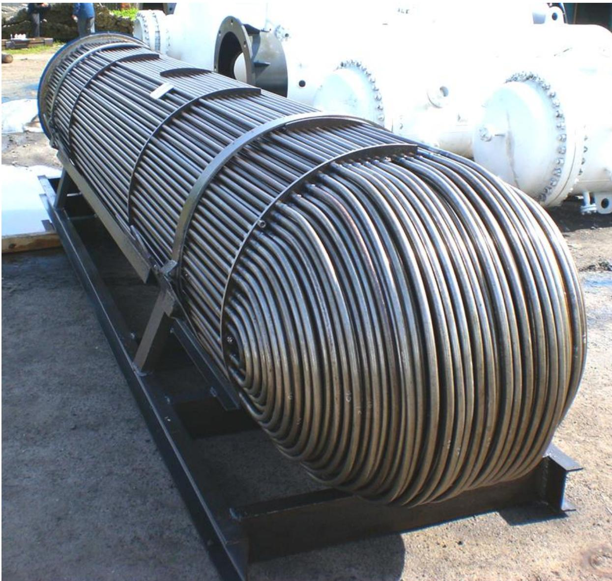
*Рис. 2.14. Трубный пучок с U-образными трубами*
