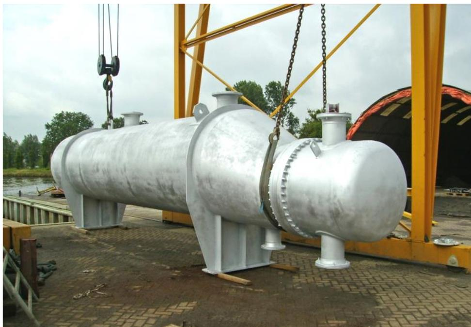
*Рис. 9.2.* Внешний вид ребойлера – кипятильника с паровым пространством
