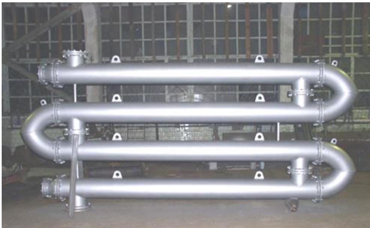
Рис. 2.2. Фотография теплообменника «труба в трубе»<sup>3</sup>
