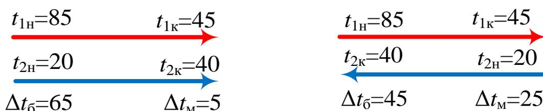
Рис. 15.1. Иллюстрация расчёта средней разности температур для прямотока и противотока
