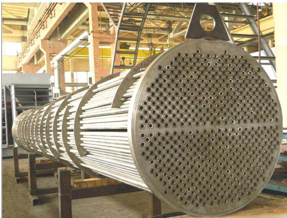
Рис. 2.5. Трубные пучки кожухотрубчатых теплообменников с перегородками в межтрубном пространстве<sup>4</sup>
