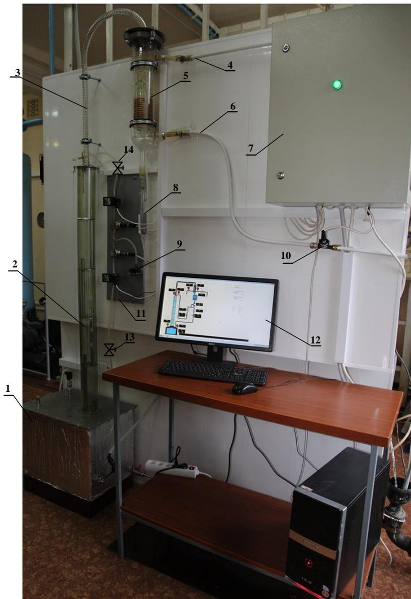
Рис. 9. Лабораторная ректификационная установка
