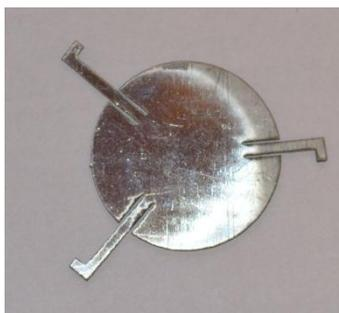
Рис. 8. Внешний вид клапана и его заготовка
