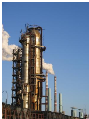
А так выглядит современная ректификационная установка
