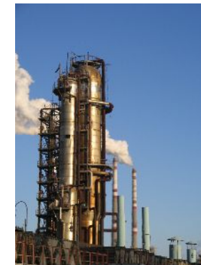
А так выглядит современная ректификационная установка
